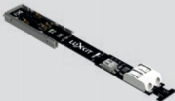
Borne de raccordement Wago pour 0,5 à 1,5 mm<sup>2</sup>, max. 4,2 A / 50 V.
