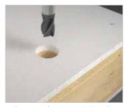
Création mécanique de l'orifice d'encastrement exact de Ø 38 mm.
