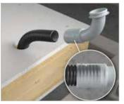
Le conduit d'installation électrique en saillie est introduit dans le logement du conduit du coude à 90° jusqu'à la butée de profondeur et enclenché.
