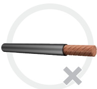
Zu intensiv verdrehte Einzeldrähte
