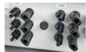
Abbildung 2: Box mit Weidmüller WM4 C Steckverbinder; in der Mitte: Druckausgleichselement
