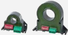
Die SIRAX® BT7000/BT7050 und SIRAX® BT7100/BT7150 Reihe sind Stromwandler mit integrierter Messumformer-Funktionalität zur Überwachung von 1-phasigen AC- oder DC-Anwendungen. Die Strommessung erfolgt galvanisch getrennt zur gemessenen Leitung. Die grosse Anzahl der gemessenen Variablen, der maximale Strom von bis zu 300 AAC bzw. 400 ADC ermöglichen einen vielseitigen Einsatz der Geräte.
