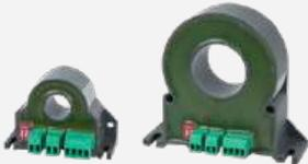
Die SIRAX® BT7200/BT7250 und SIRAX® BT7300/BT7350 Reihe sind Stromwandler mit integrierter Energiezähler-Funktionalität zur Überwachung von 1-phasigen AC- und DC-Anwendungen. Die grosse Anzahl der gemessenen Variablen, der maximale Strom von bis zu 300 AAC bzw. 400 ADC bei maximalen 1000 VDC bzw. 800 VAC ermöglichen einen vielseitigen Einsatz der Geräte.
