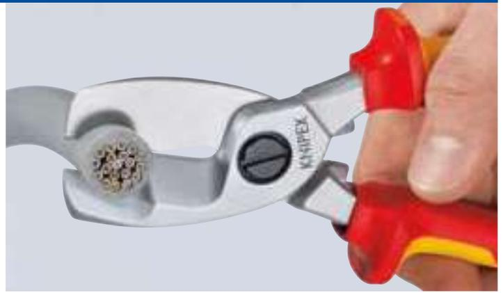
**Vorschnitt:** Durch Einsatz der vorderen Schneide zum Schneiden des Isoliermantels bei größeren Kabeldurchmessern bleibt eine ergonomische Griffweite erhalten.
