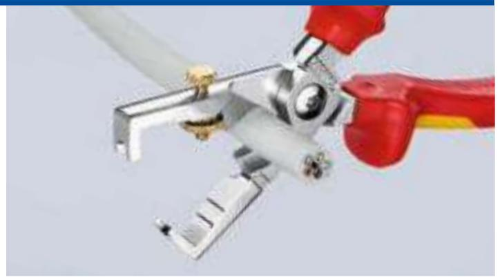
Induktiv gehärtete Scherschneide mit Präzisionsschliff zum quetschfreien Schneiden von Kupferkabeln bis Ø 15 mm (5 x 2,5 mm<sup>2</sup>)
