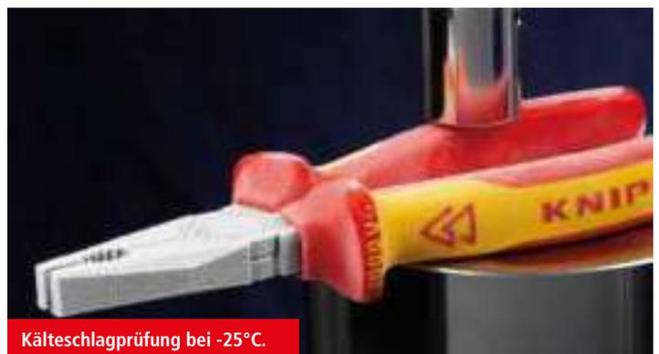
Kälteschlagprüfung bei -25°C.
