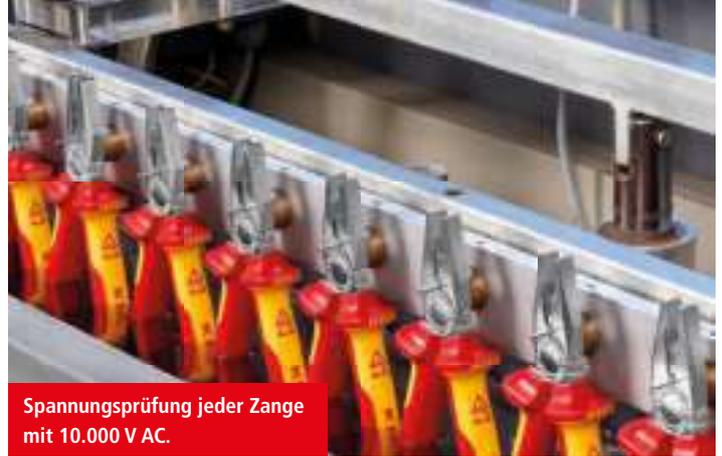
Spannungsprüfung jeder Zange mit 10.000 V AC.
