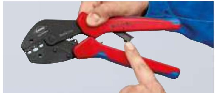
Service-Hebel einklappen und Zange durchdrücken – bereit für den nächsten Einsatz
