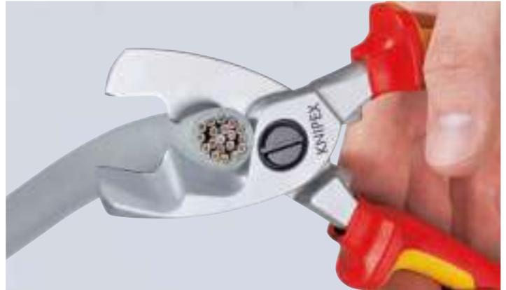
**Nachschnitt:** Nachdem der Mantel des Kabels im vorderen Profil durchgeschnitten wurde, werden die Leiter im hinteren Profil durchtrennt. Vorschnitt vorn, Nachschnitt hinten - so schneidet es sich leichter.
