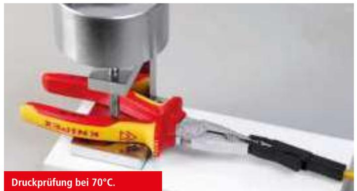
Druckprüfung bei 70°C.
