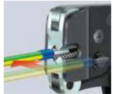
97 53 08: Einführen von Aderendhülsen parallel von der Seite bis 2,5 mm<sup>2</sup> z. B. unter beengten Platzverhältnissen
