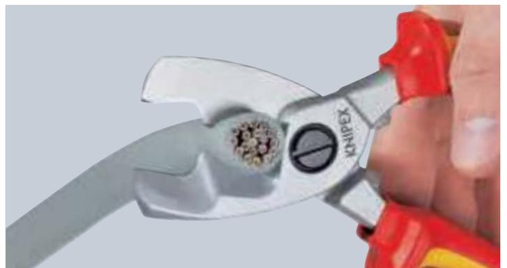
**Coupe définitive :** une fois la gaine du câble coupée dans le profil avant, on coupe les conducteurs dans le profil arrière. Coupe préliminaire à l'avant, coupe définitive à l'arrière – la coupe est plus facile.
