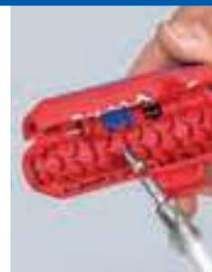
Dénudage d'un câble coaxial
