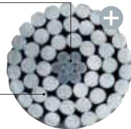
L'extérieur de ces câbles est constitué de légers fils d'aluminium à haute conductibilité, l'âme de fils d'acier galvanisé particulièrement résistants à la dilatation
